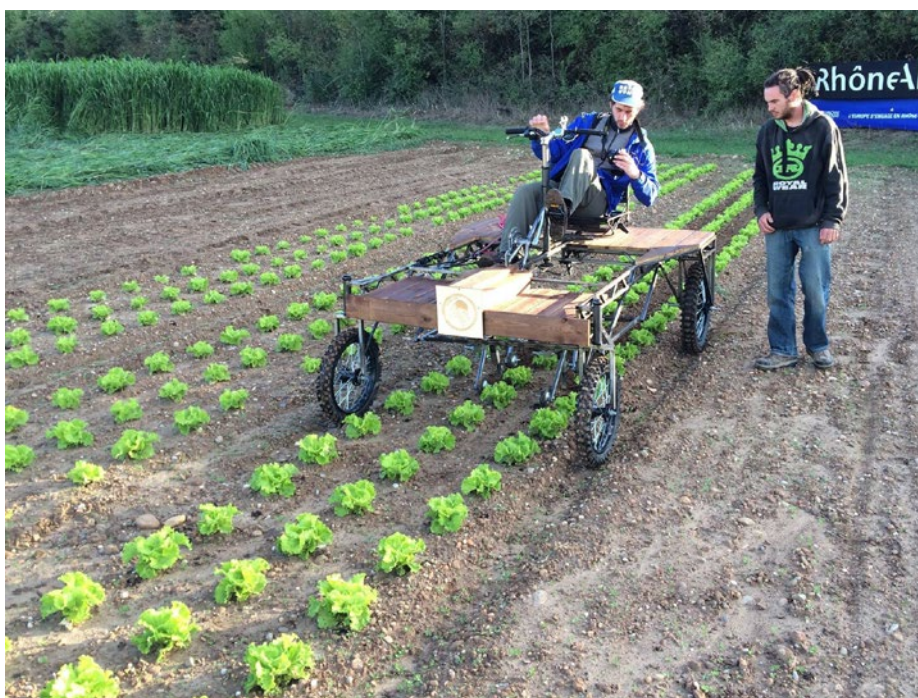
L'agrozouk, anciennement appelé "bicitractor", est un engin à pédale, muni d'une assistance électrique, auquel sont attelés des outils agricoles. Il est développé notamment par L'Atelier paysan.
